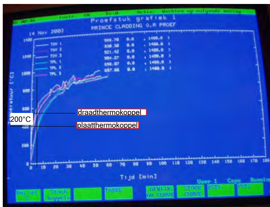
Figuur 2: Meting temperatuur in oven volgens NEN 6069 en NEN-EN 1366-3
