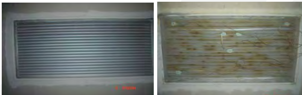
Foto 8 & 9 : bij verhitting opschuimend rooster
